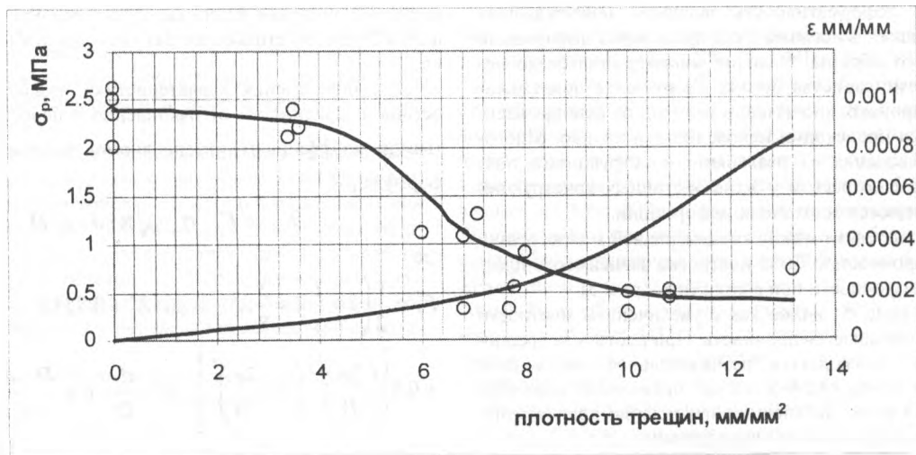
Рис. 5. Зависимость прочности и предельных относительных деформаций при растяжении от плотности трещин.
