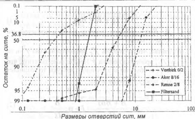
Рисунок 3. Диаграмма Rosin-Raimmler распределения зернового состава для заполнителей согласно [10]
