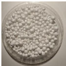
*Рисунок 5.8 – Зерна полистирола, вспененного горячей водой*
