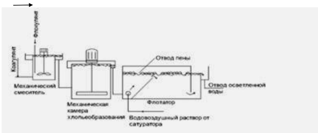
*Рисунок 1.20 – Технологическая схема осветления и обесцвечивания гумусово-карбонатно-кальциевых вод*
