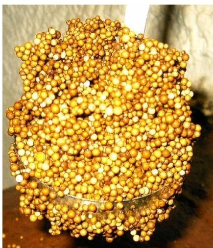
**Рисунок 5.6 – Вспененная загрузка, покрытая оксидами железа**
