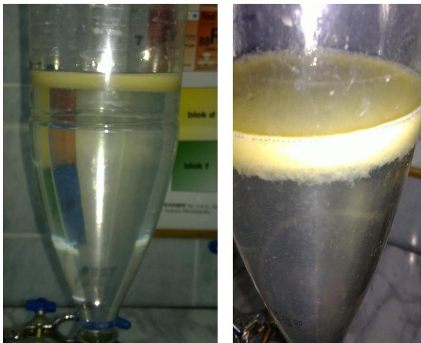
***Рисунок 1.24 – Пенный конденсат при обесцвечивании природной поверхностной воды напорной реагентной флотацией***
