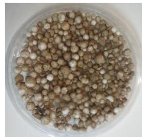
*Рисунок 5.9 – Зерна полистирола, вспененного в среде горячего зернистого материала*
