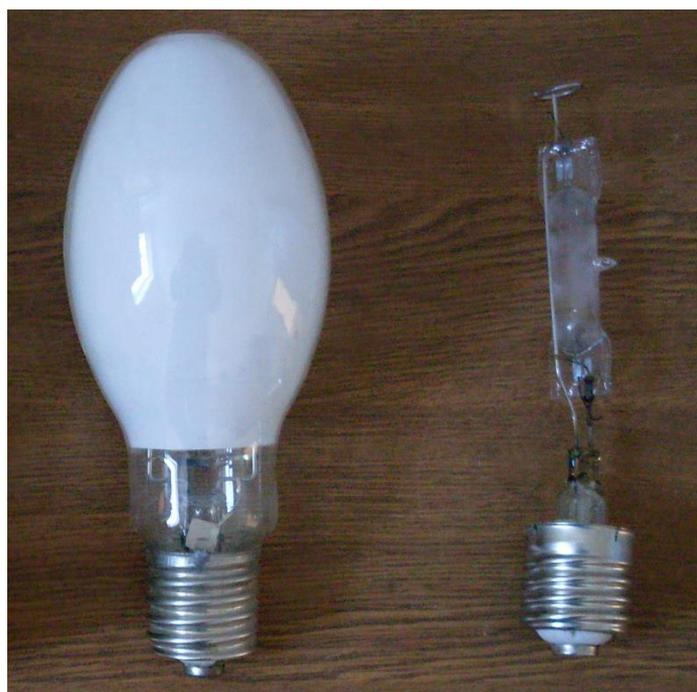
Рисунок 3.9 – Лампа ДРЛ-250 (слева), кварцевая ртутно-аргоновая горелка (справа)
