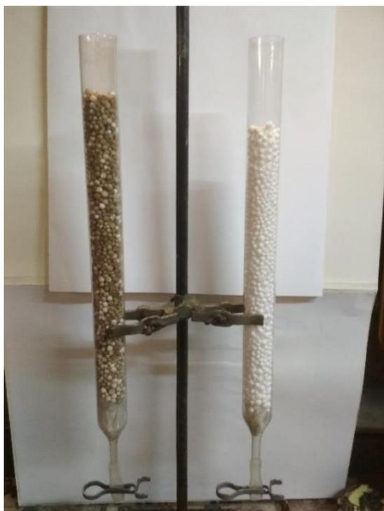
*Рисунок 5.10 – Зерна полистирола, вспененного в среде горячего зернистого материала и горячей воде*
