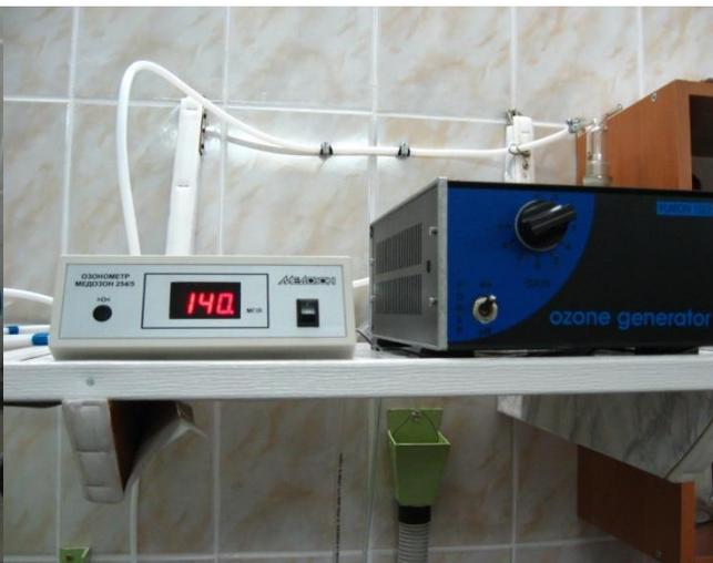
*Рисунок 1.12 – Озонатор «Platon 10/2» и озонметр*
