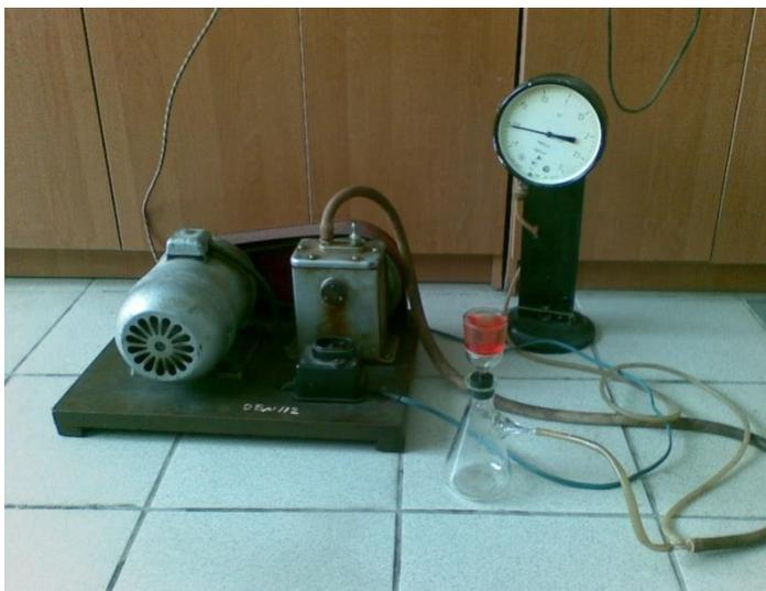
*Рисунок 4.14 – Общий вид установки для фильтрации под вакуумом*
