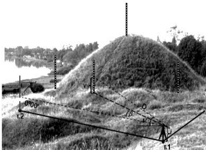
Рис. – Сущность тахеометрической съёмки
