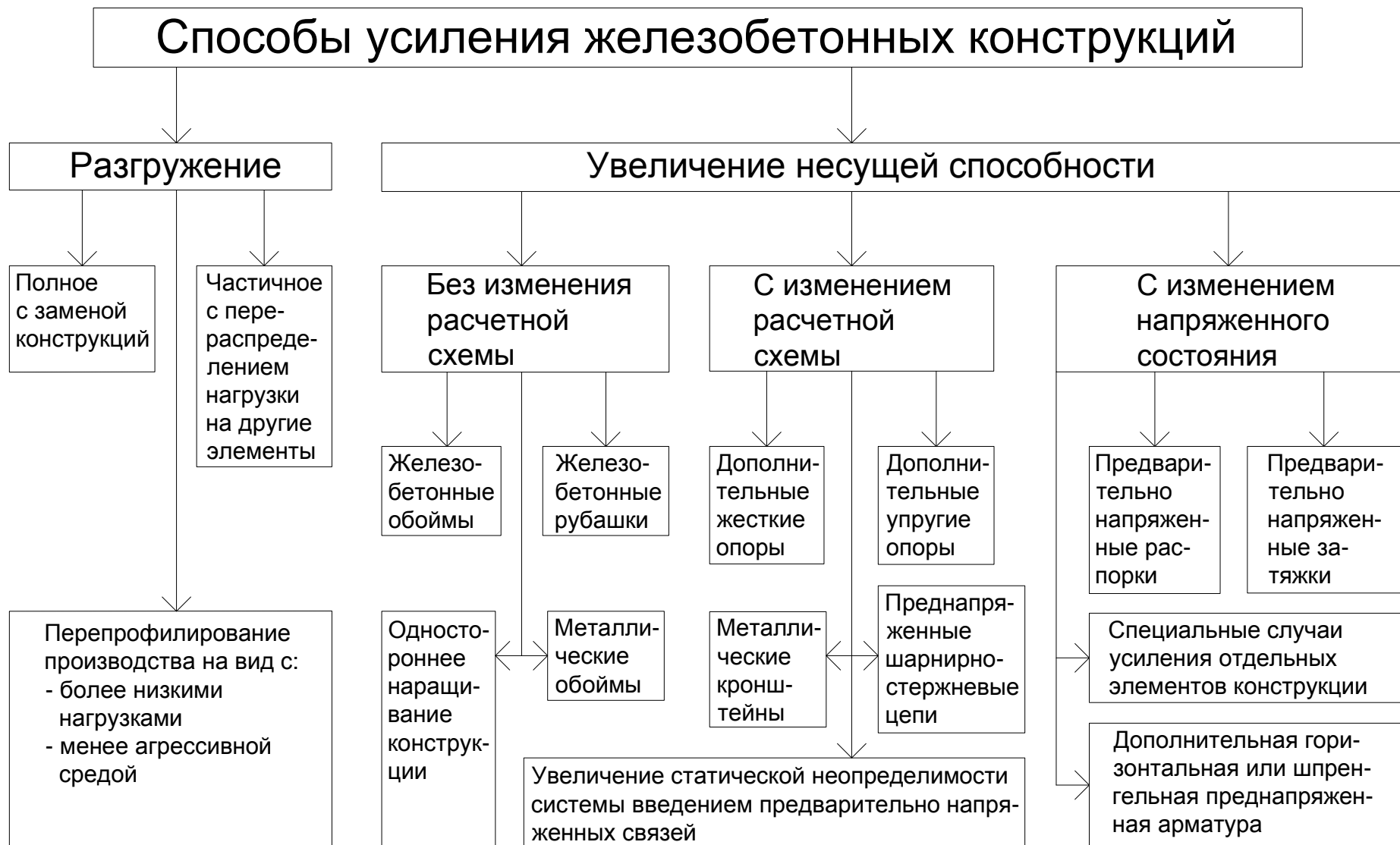
Рисунок 3.1 Классификация способов усиления железобетонных конструкций
