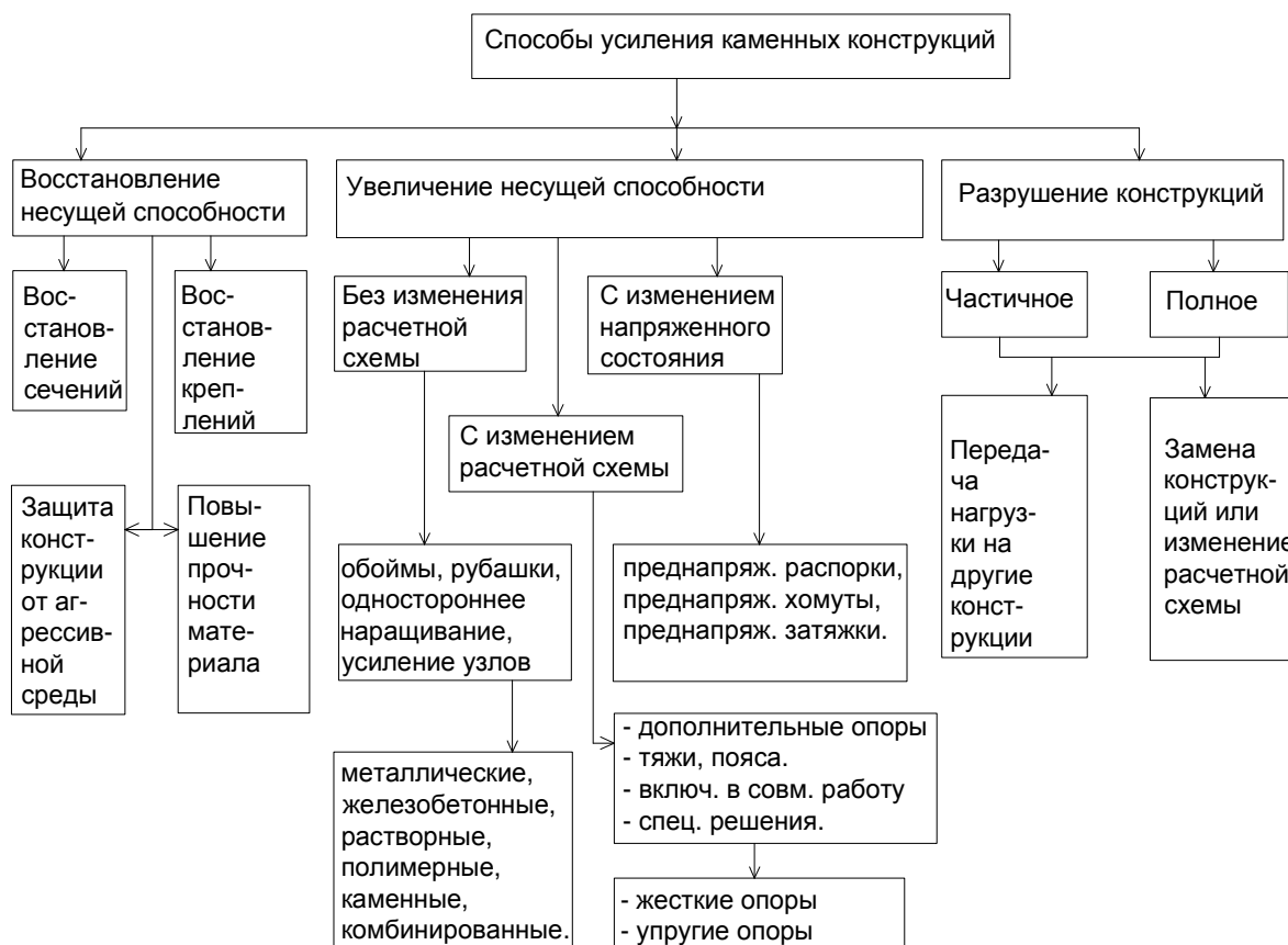
Рисунок 12.1 – Классификация способов усиления конструкций из каменных материалов
