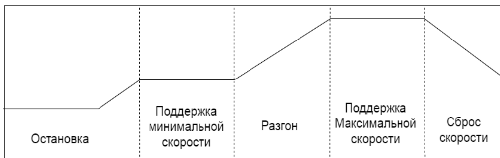
Рисунок 1 – Состояния работы электрокара “Инфобус”
