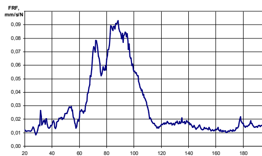
Рисунок 2 – Volkswagen Polo. Изгиб. АЧХ автомобиля, осреднённая по всем сканируемым точкам
