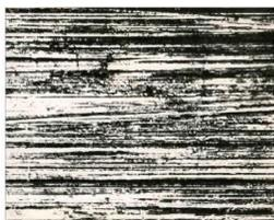
Рисунок 8. Поверхность после шлифования (фото, x500)
