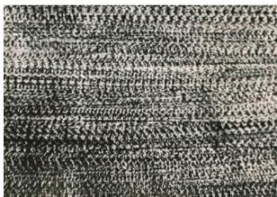
Рисунок 7. Поверхность после ультразвукового упрочнения (фото,  $\times 500$ )
