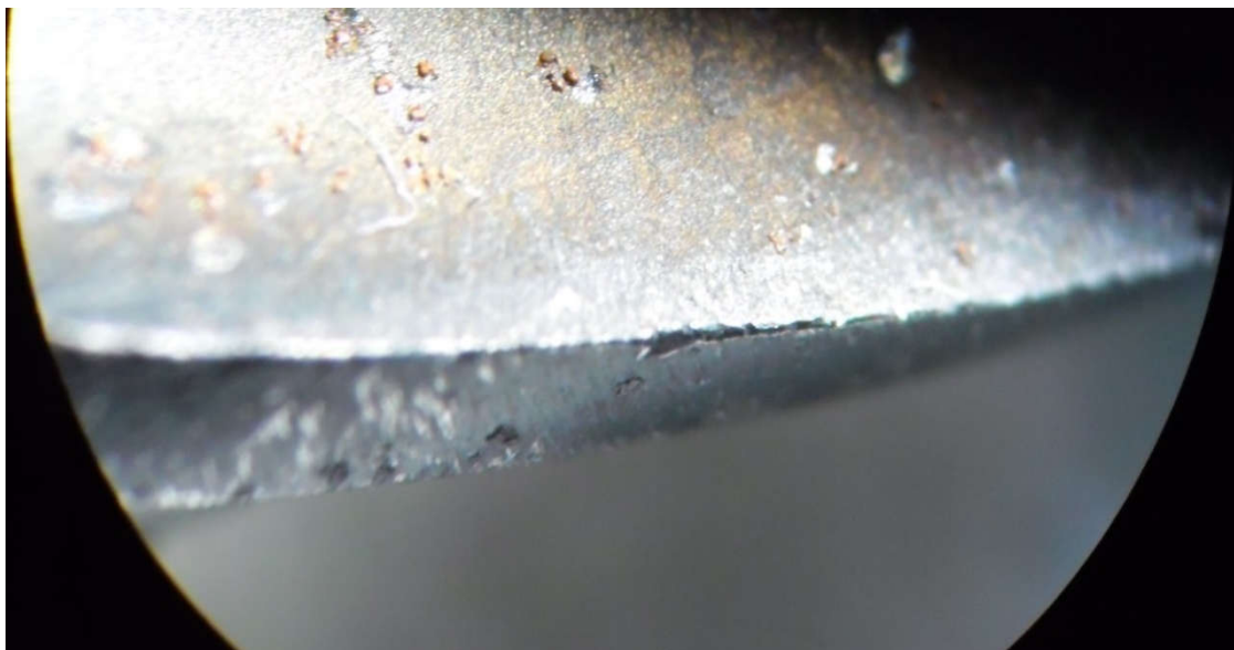
Рисунок 2 — Режущая кромка сверла до азотирования
