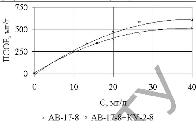
**Рис. 4.** Изотерма сорбции красителя цибакрона суперчерного R
