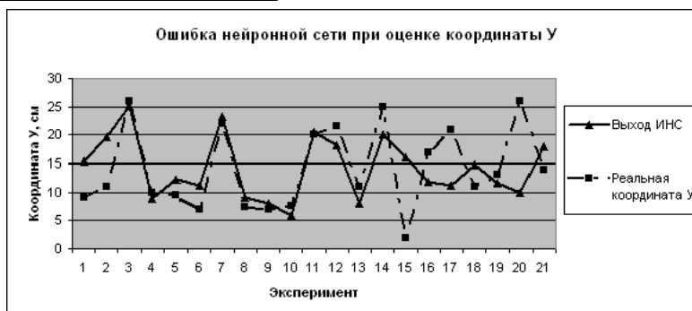
Рисунок 3 – Аппроксимация ошибки одометров нейронной сетью
