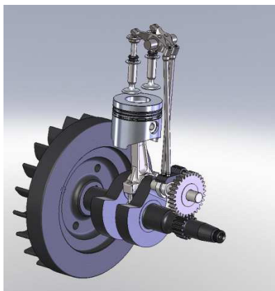
Рисунок 3. 3D-сборочная модель кривошипно-шатунного механизма
