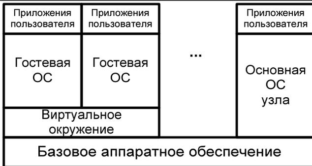
Рис. 1. Архитектура средств виртуализации
