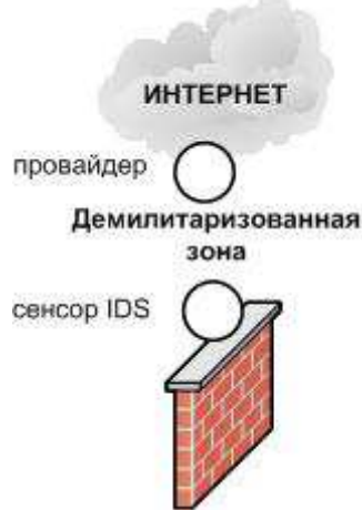
Рис. 3. Размещение сенсора IDS на границе локальной сети
