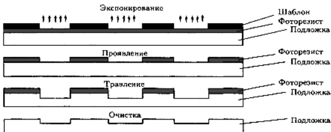
Рис. 1. Процесс формирования микрорельефа в подложке
