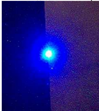
Рис. 3 – Излучение квантоворазмерной гетероструктуры InGaN/GaN/Si после достижения порога генерации.
