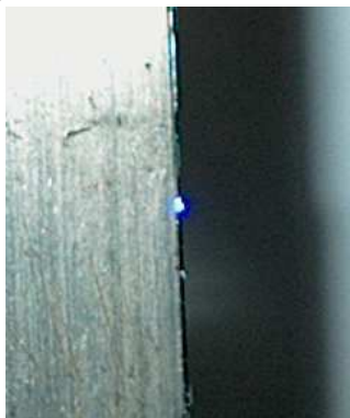
Рис. 2 – Излучение квантоворазмерной гетероструктуры InGaN/GaN/Si до достижения порога генерации.
