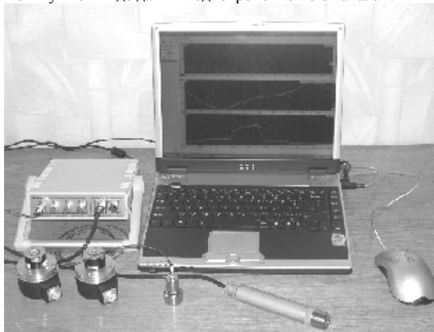
Рис. 1. Аппаратно-программная система для исследования и диагностики механических объектов.
