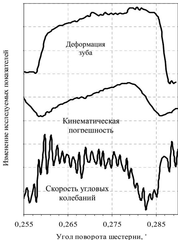
Рис. 6. Деформация зуба шестерни, кинематическая погрешность и угловая скорость, возникающие при работе пары зубьев
