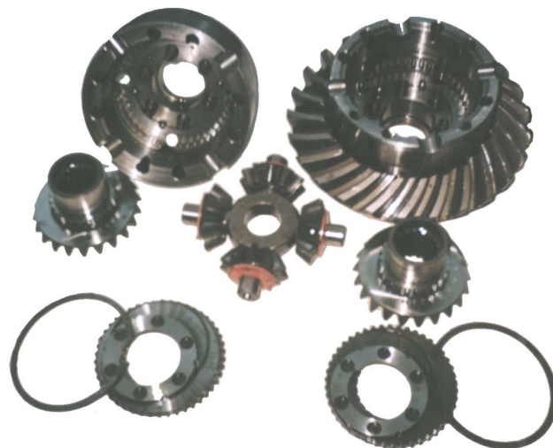
Рис. 2. Дифференциал повышенного трения с улучшенной характеристикой блокирующих свойств в разобранном виде
