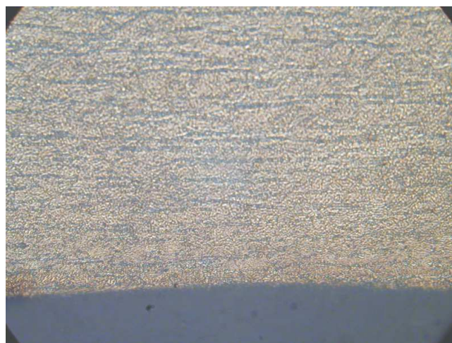
Рис. 4. Микроструктура стали 14X17H2 при повторной обработке в защитной среде аргона.
