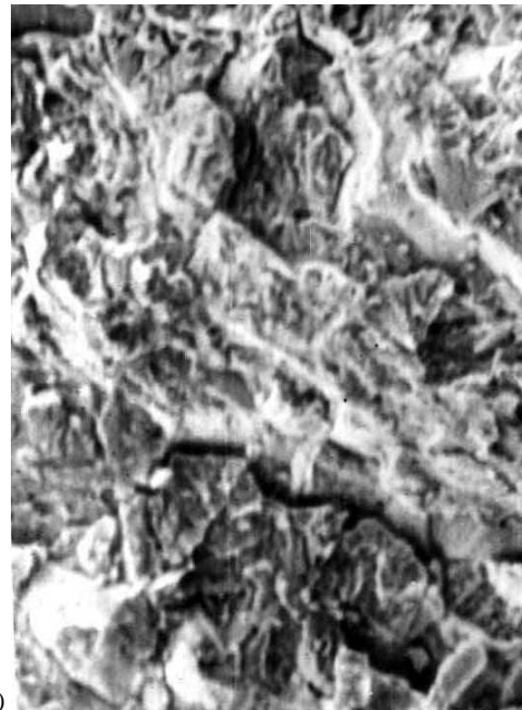
Рис. 2. Фрактограммы поверхности разрушения твердого сплава ВК8-В, полученного одностадийным МТФ (а - при увеличении в 300 раз, б - при увеличении в 2000 раз).
