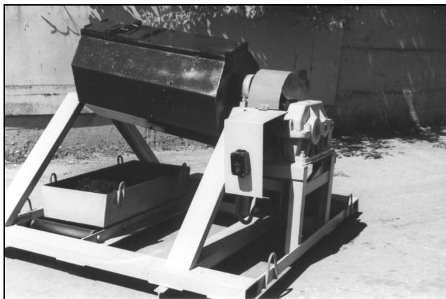
Рисунок 1 – Машина для измельчения битумосодержащих материалов (ИСБ-1).
