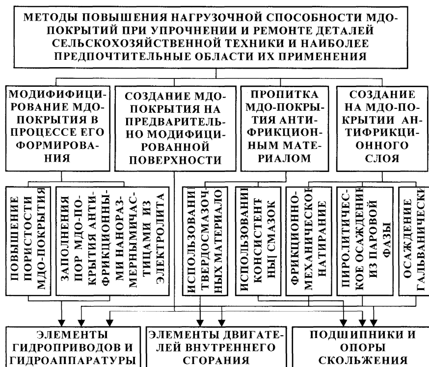
Рис. 1. Методы модифицирования МДО-покрытий для улучшения их триботехнических свойств.
