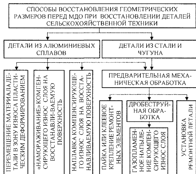
Рис. 3. Способы восстановления геометрических размеров изношенных поверхностей.
