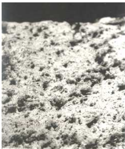
Рис. 1. Микроструктура покрытий \text{Ni80Cr20} + 12,5\% \text{MoS}_2(\text{CaF}_2) + 55\% \text{TiC} после лазерной обработки (x 100).
