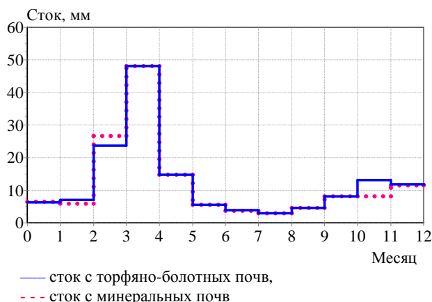
Рис. 1. Измеренный и рассчитанный сток р. Ясельда в створе г. Береза
