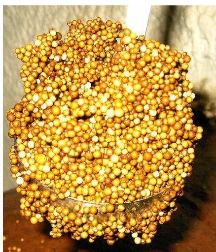
Рис. 7. Вспененная загрузка, покрытая окислами железа
