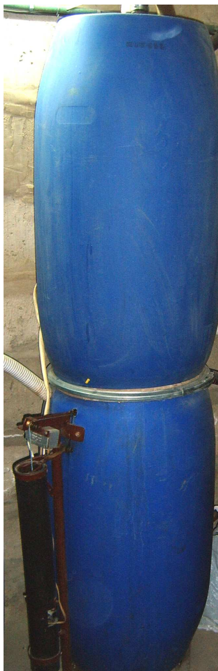
Рис. 1. Общий вид установки для обезжелезивания воды «сухой фильтрацией» с блоком автоматики
