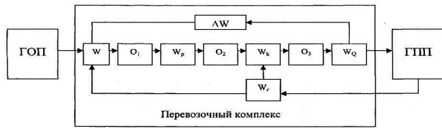
Рис. 4. Принципиальная схема организации перевозки груза в строительстве
