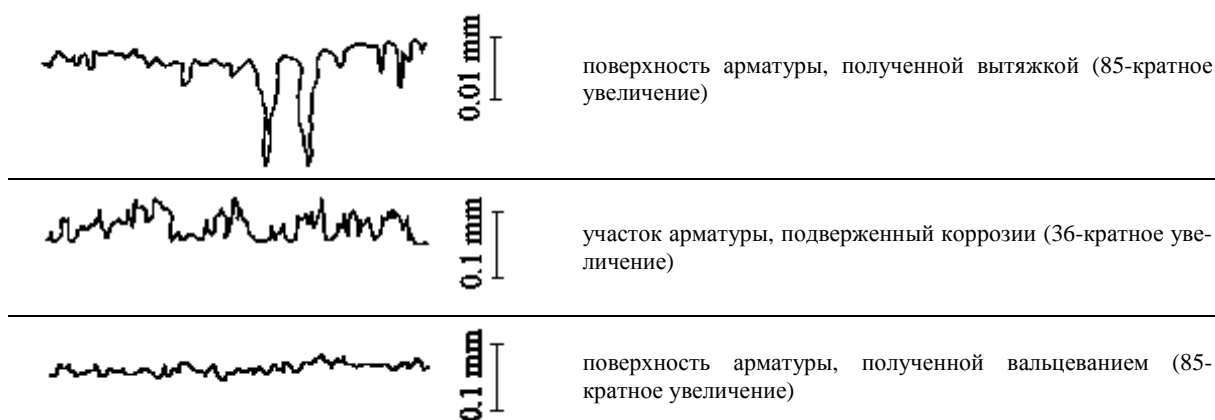
Рис. 1. Характеристики шероховатости поверхности гладких арматурных сталей (результаты ультразвуковых исследований) [11]
