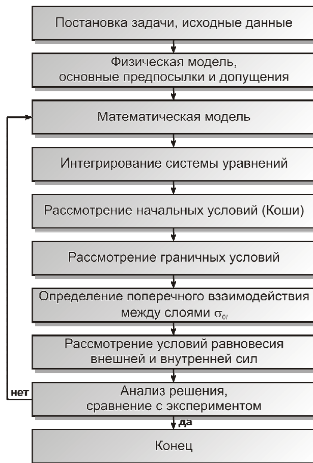
Рис. 1. Алгоритм расчёта прочности слоистого сталебетона
