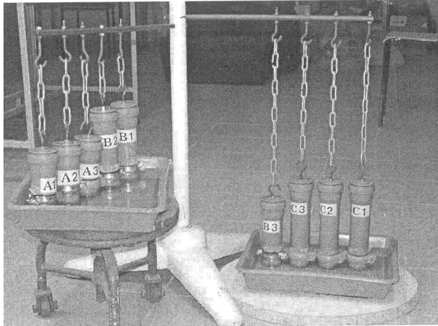
Рис. 1. Лабораторная установка для изучения процессов влагопереноса в зерновой среде (а); вид образца с зерном пшеницы (б).
