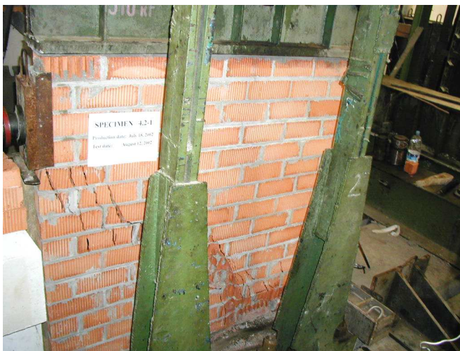
Рис. 7. Характер разрушения опытных образцов. Слева – общий вид, справа – разрушение у горизонтальной опоры.
