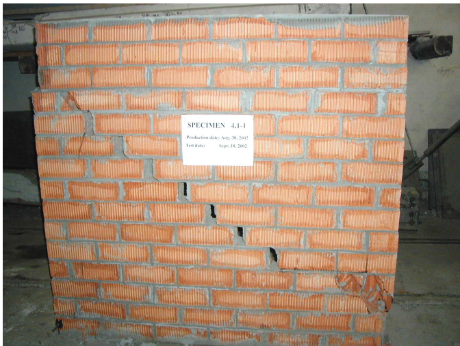
б) Образцы серии 2 ( P_{ult}=192,6 кН)
