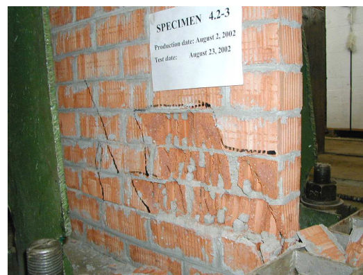
Рис. 7. Характер разрушения опытных образцов. Слева – общий вид, справа – разрушение у горизонтальной опоры.
