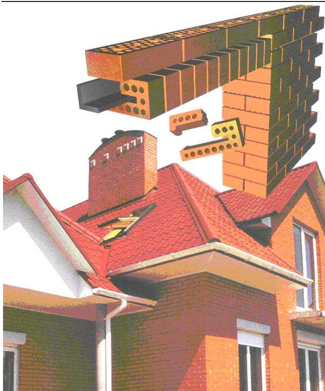
Рис. 9. Маскировка несущих в проемах
