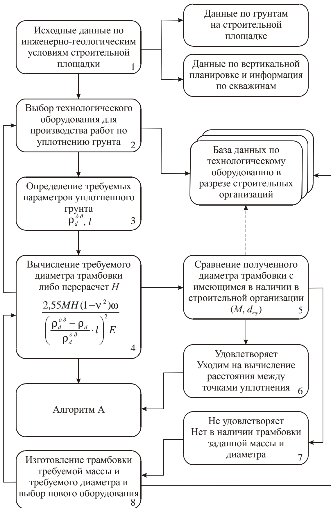
Рис. 1. Алгоритм проектирования уплотнения грунта интенсивными ударными нагрузками
