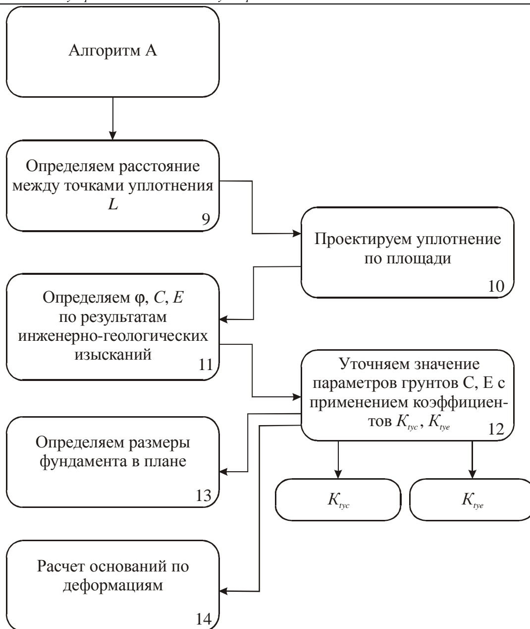
Рис. 2. Алгоритм А. Проектирование уплотнения по площади и расчет фундаментов
