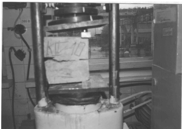
Рис. 1. Разрушение образцов при испытаниях на нормальный отрыв.
