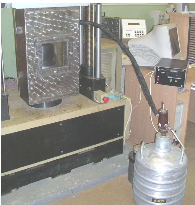
Рис. 1. Общий вид установки для испытаний ДКБ-образцов: термокамера с установкой для автоматического регулирования температуры.
