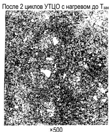
Рис. 4. Микроструктуры термически упрочненных фрез из быстрорежущей стали P18
