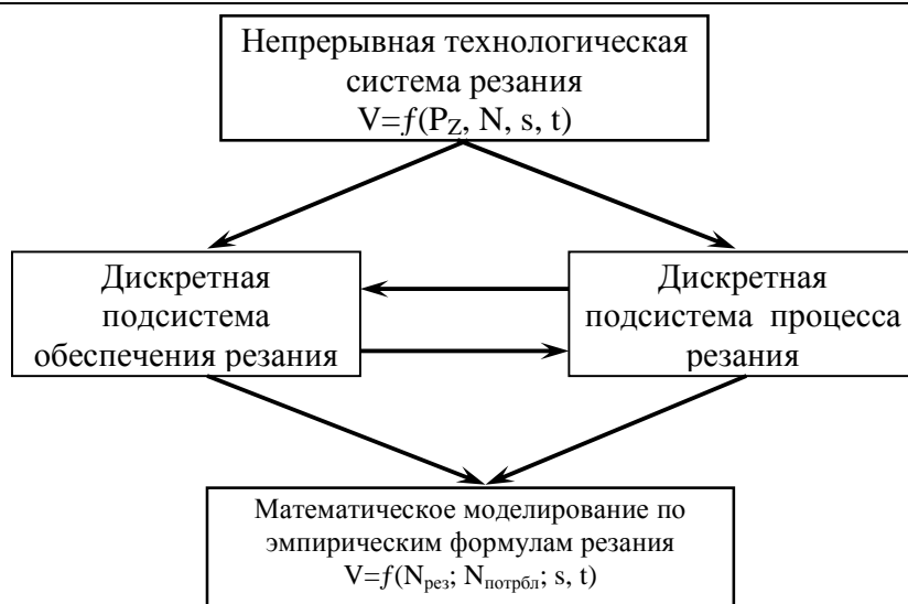
Рис. 1. Структурная технологическая схема процесса резания
