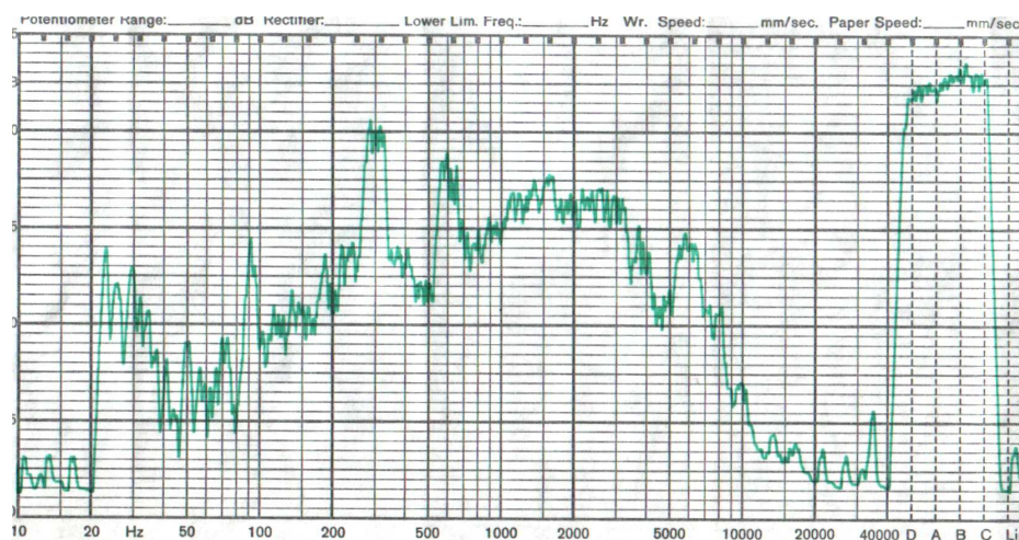
Рис. 2. Спектр шума серийной зубчатой передачи при частоте вращения ведущей шестерни 1000 мин -1
