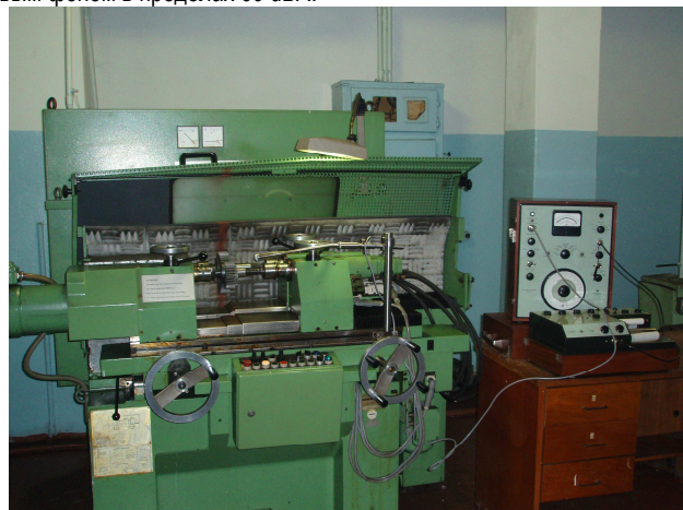
Рис. 1. Общий вид контрольно-обкатного станка с аппаратурой для измерения шума
