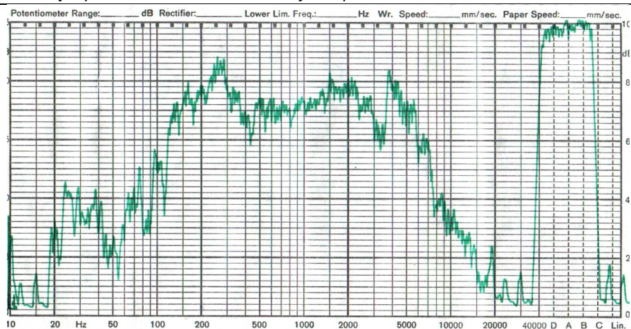
Рис. 4. Спектр шума экспериментальной зубчатой передачи №2 при частоте вращения ведущей шестерни 1000 мин -1
