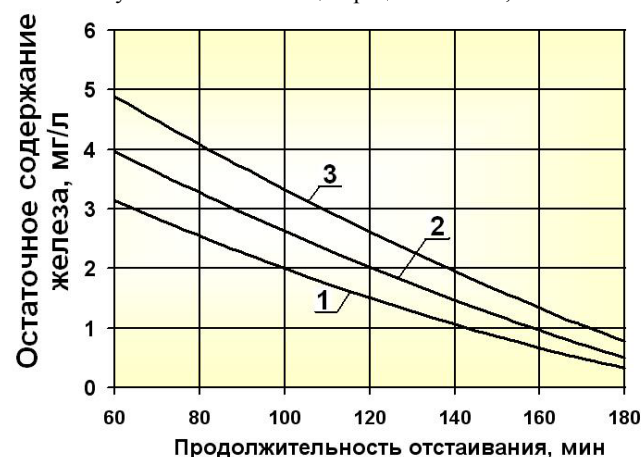
Рис. 3. Влияние времени отстаивания на остаточное содержание железа, доза фосфорнокислого натрия 50 мг/л
