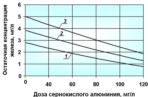
Рис. 2. Влияние дозы сернокислого алюминия на остаточное содержание железа в промывных водах при дозе фосфорнокислого натрия 50 мг/л
