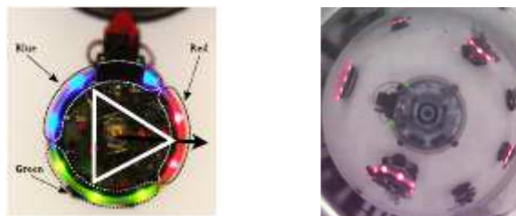
Рис. 1. Триангуляционный паттерн, формируемый светодиодами робота
