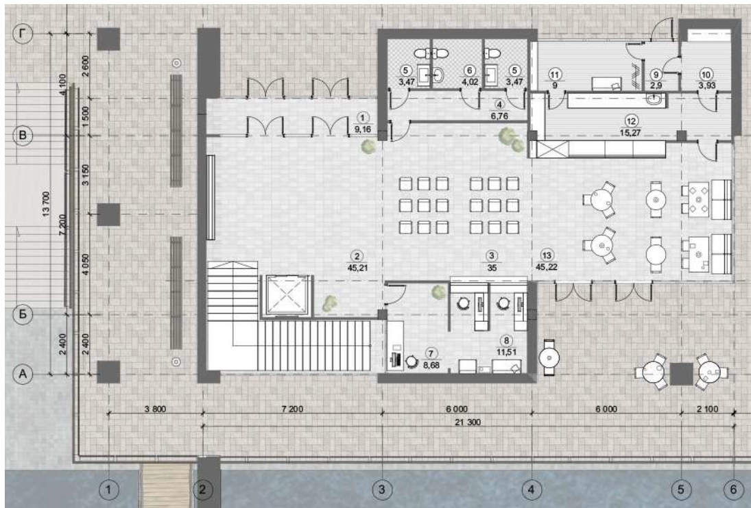
Рисунок 5 – Речной вокзал, план 1-го этажа
