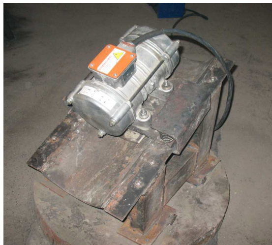
Рисунок 5. Модель и экспериментальная рессорно-стержневая мельница
