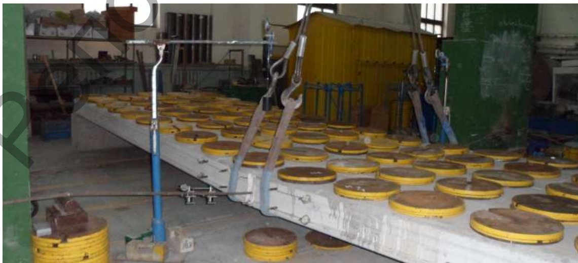
Рисунок 8 – Диск перекрытия после полной передачи нагрузки через сутки
