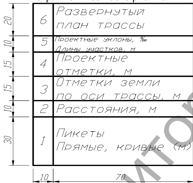
Рисунок 2.3 – Расположение и размеры граф профильной сетки
