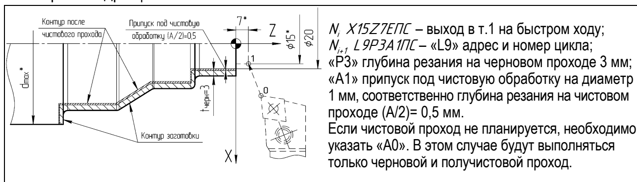
Рисунок 23 – Схема реализации цикла многопроходной обработки заготовок из проката L9
