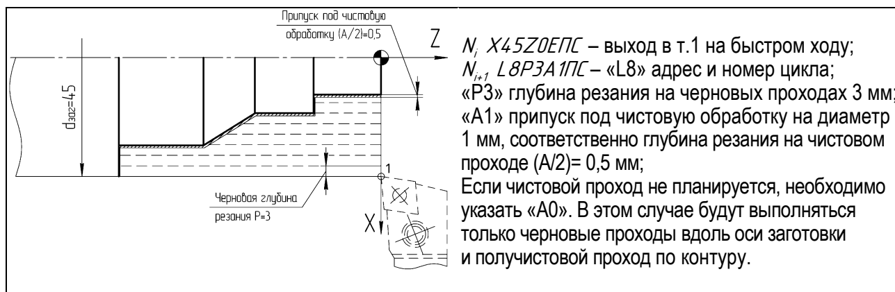
Рисунок 22 – Схема реализации цикла многопроходной обработки заготовок из проката L8
