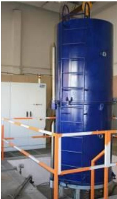
*Рисунок 1 – Установка ионно-плазменного азотирования ФТИ НАН РБ*
