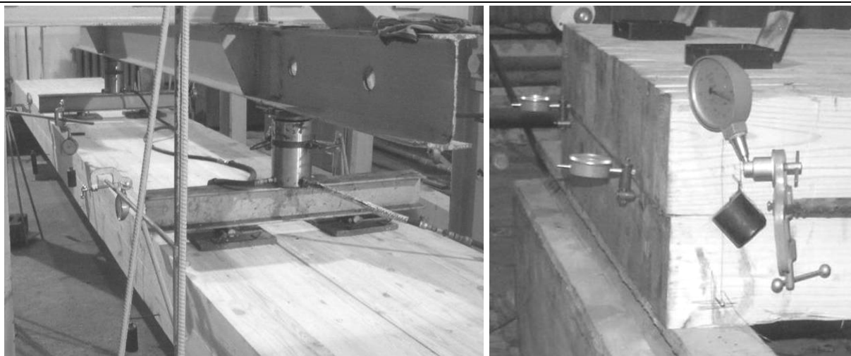
Рис. 4. Нагружение балки, измерительные приборы
