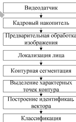
Рис. 1. Структура системы видеонаблюдения
