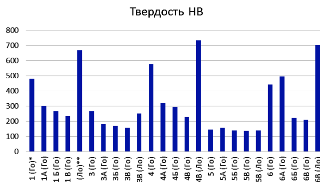
Рисунок 9 – Диаграмма результатов определения твердости образцов покрытий
