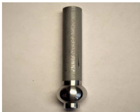
Рисунок 3 – Фотография перекидного переключателя коммутационной аппаратуры после МАО
